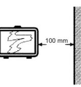
Prilikom montaže vodite računa da bočno od reflektora nema prepreke najmanje 10 cm.
