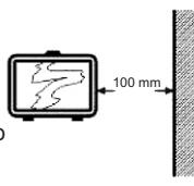
Prilikom montaže vodite računa da bočno od reflektora nema prepreke najmanje 10 cm.
