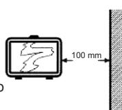
Prilikom montaže vodite računa da bočno od reflektora nema prepreke najmanje 10 cm.
