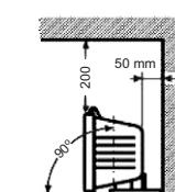
Ukoliko reflektor montirate na zid ostavite najmanje 20cm do plafona, udaljite poleđinu 5 cm i postavite ga pod uglov od 90 stepeni.
