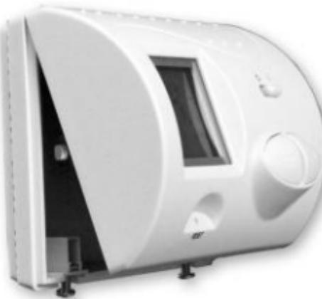
Pomoću priloženih zavrtnja, pričvrstite (fiksirajte) poleđinu uređaja na zid. Odstranite oblogu redne (serijske) kopče sa unutrašnje strane poleđine, pomoću malog odvijača (šrafcigera). Izlazni relj termostata raspolaže sa tri priključne tačke (bez potencijala): **1** (NO); **2** (COM); **3** (NC), koje se nalaze na unutrašnjoj strani poleđine, smeštene ispod maske. Ukoliko želite regulisanje grejanja, tada dva priključna voda uređaja treba da priključite na serijsku kopču.
