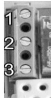
**PAŽNJA!** Montiranje uređaja i priključivanje na mrežu svakako prepustite stručnom licu! Prilikom priključivanja termostata na grejni ili rashladni uređaj, svakako treba uzeti u obzir i uputstva za priključivanje koje je propisao proizvođač uređaja. Napon kod kopče 1, 2, ili 3, zavisi isključivo od sistema kojim se upravlja, zbog toga dimenzije vodova koji će se upotrebiti, određuje tip sredstva kojim se upravlja. Dužina voda može da bude različita.
