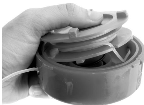
Bubanj postavite u donji deo glave. Budite oprezni da nit ne ode pod bubanj za namotavanje.
