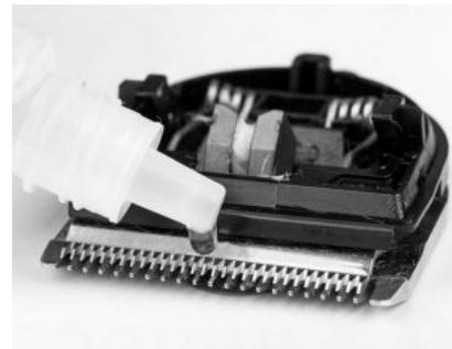
**Važno:** kako bi se obezbedio duži vek trajanja aparata, bitno je da se glava oštice redovno podmazuje. Zbog nedostatka uljnog filma trljanjem metala od metal glava oštice se brzo troši.
