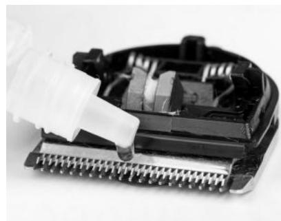
**Važno:** kako bi obezbedili dug radni vek uređaja važno je da glavu oštrice redovno uljite. Kod nedostatka uljnog filma dolazi do trljanja metala od metal te glava oštice se brzo troši.
