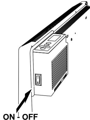
Pomoću dugmeta za napajanje / stanje pripravnosti uključite i isključite konvektor bez gubitka sačuvanog vremena.
