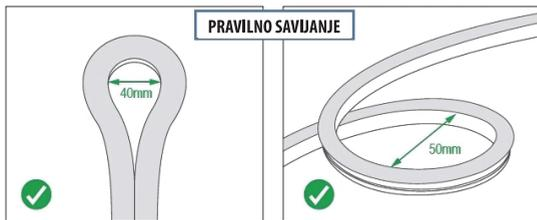
Minimalni prečnik savijanja je 40 mm
