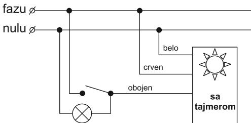
**Varijanta "B":** Kada prekidac za osvetljenje prekida nulu.
