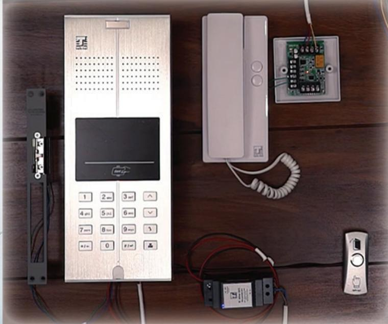
Ceo sistem se prvo može programirati na stolu u radionici pre ugradnje na zgradi. Na taj način, sama ugradnja i instaliranje sistema traje minimalno, koliko je potrebno da se sistem mehanički postavi.
